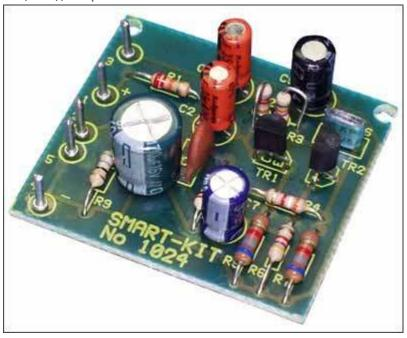
Микрофонный усилитель предназначен для работы с динамическими микрофонами. Его можно использовать в качестве высокочувствительного предварительного усилителя для передатчиков, усилителей низкой частоты, акустических реле и других электронных устройств.
