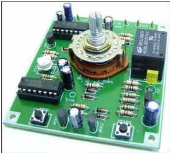
**NEW!** Предлагаемый набор позволит радиолюбителю собрать простой и надежный таймер, позволяющий включить какой-либо электроприбор на заданный интервал времени (от 7 секунд до 10-ти часов). По истечении установленного времени таймер автоматически выключит электроприбор. Такой прибор может иметь широкое применение в быту, в кулинарии, в радиолюбительской практике, в фотолaborатории и т. д.
