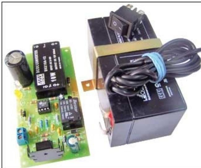
Предлагаемый набор позволит радиолюбителю собрать источник бесперебойного питания. Аккумуляторная батарея емкостью 1,3 Ач входит в состав комплекта. Устройство найдет применение для зарядки мобильных телефонов, питания
