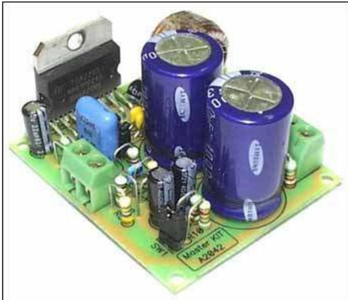
Предлагаемый набор позволит радиолюбителю собрать простой и надежный мощный усилитель НЧ, обладающий малыми габаритами, минимальным числом внешних пассивных элементов обвязки, широким диапазоном питающих напряжений и сопротивлений нагрузки.
