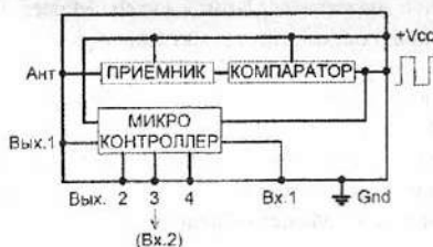
Рис.2 Структурная схема приемника
