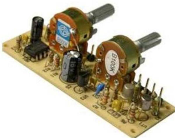
Модуль подготовки сигнала для сабвуфера KE663, включает в себя сумматор (L+R), предварительный УЗЧ, фильтр низких частот и фазовращатель. Два потенциометра регулируют частоту среза фильтра (40-220 Гц) и фазовый сдвиг (0-180). Размер платы 78x22мм.
