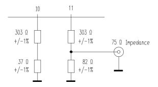
test circuit attenuation : 26 dB
