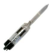
Благодаря низкой стоимости и высокой надёжности, ПМИ-2 (манометрический ионизационный преобразователь) самый распространённый в России ионизационный датчик.
