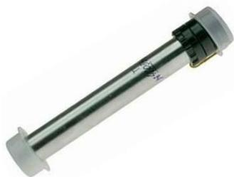
Манометрический преобразователь терморезисторный (лампа ПМТ-6-3) относится к классу тепловых (конвекционных) вакуумных датчиков. Предназначен для работы в составе вакуумметров 13ВТ3-003 и аналогичных. используется в составе большинства современных вакуумметров. К вакуумному объёму присоединяется посредством грибкового (компрессионного) соединения с резиновым уплотнением.
