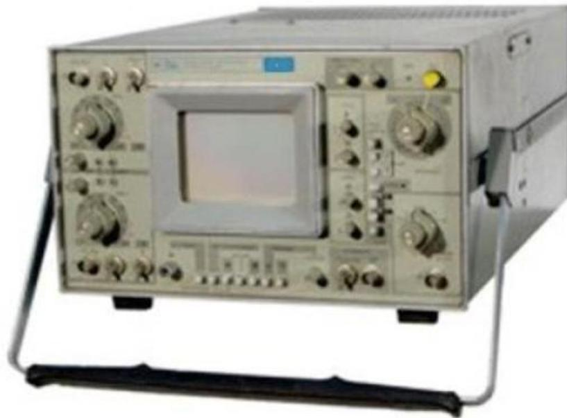
С8-17 выполнен с использованием бистабильной запоминающей ЭЛТ, имеет сравнительно высокую скорость записи (40 км/с) при длительном времени воспроизведения (30 мин). В приборе С8-17 предусмотрены дистанционное и ручное стирание изображения, регулируемое время воспроизведения в пределах 1-5 с в режиме автоматического стирания, повторная запись сигнала без стирания ранее записанного сигнала, режимы X-Y, внешняя модуляция яркости луча.
