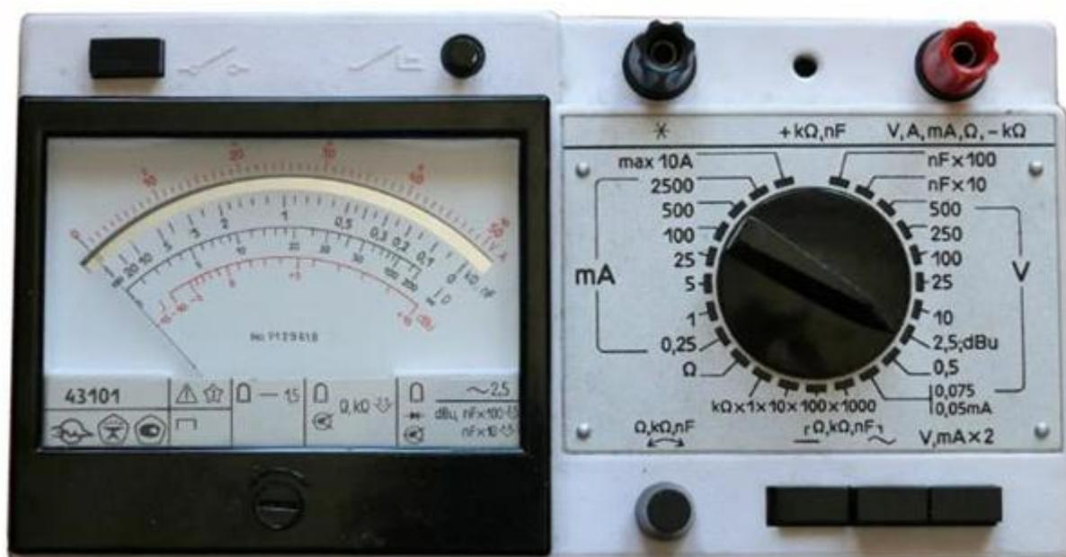
**Ц43101 тестер** используется для измерения в электрических цепях объектов измерений, для которых взаимодействие с прибором не нарушает работоспособное состояние.
