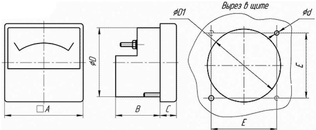
где А - 80мм, В - 36мм, С - 14мм, D - 70мм, D1 - 77,5мм, d - 3,4мм, Е - 68,2мм;
