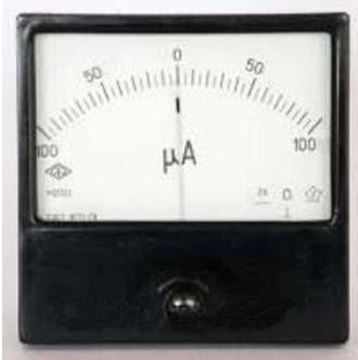
Микроамперметр М42304 предназначен для измерений силы тока в электрических цепях постоянного тока. Приборы представляют собой щитовые приборы магнитоэлектрической системы с внутрирамочным магнитом; Измерительный механизм прибора состоит из магнитной системы (обойма, магнитопровод), отсчетного устройства (шкала, указатель) и подвижной части на кернах;
