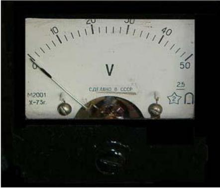
Вольтметр М1001 предназначен для измерения постоянного напряжения в различных отраслях промышленного производства.
