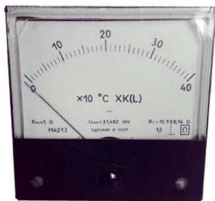
Вольтметр М4213 предназначен для измерения э.д.с. термопар стандартных градуировок ПП-1, ПР-30/6, ХА и ХК.
