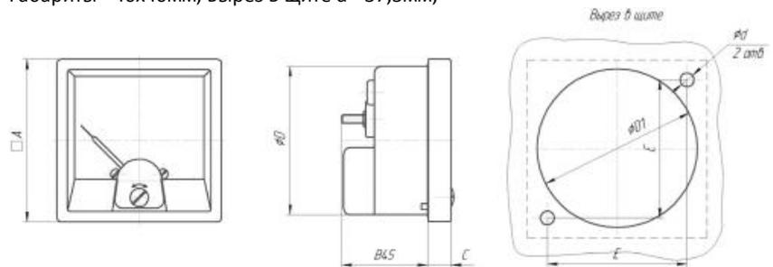
где А - 40мм, В - 36мм, С - 12мм, D - 36,1мм, D1 - 37,5мм, d - 3мм, E - 32мм;
