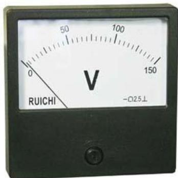
Прибор CG-80 предназначен для измерения напряжения в цепях постоянного тока. Индикатор представляет собой щитовой вольтметр магнитоэлектрической системы с подвижной рамкой и внутрирамочным магнитом. Исполнение приборов - устойчивое к воздействию пыли и брызг. Степень защиты корпусов – IP50 или IP54.
