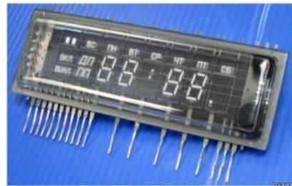
Вакуумный люминисцентный индикатор (ВЛИ) типа ИЛМ2-7Л имеет 4 цифровых 7-сегментных разряда, а также дополнительные надписи и мнемонические знаки. Цвет свечения - зелёный. Выполнен в стеклянном корпусе с 19-ю выводами для монтажа на печатную плату. Применяется для построения часов/таймера и, в частности, в видеомагнитофоне "Электроника ВМ-12" совместно с микросхемой [КР1005ВИ1](#).
